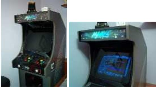
Como corazón de la máquina le metí una placa base (PII a 350Mhz) con 128Mb de memoria y 2 discos duros de 3 Gb. Como sistema operativo DOS, como Frontend [ArcadeOS](#) y como emulador de máquinas recreativas [Mame](#). Para hacer la conexión del PC a la máquina (con su conector Jamma) lo primero que construí fue el conversor descrito en la página [PC2JAMMA](#).
