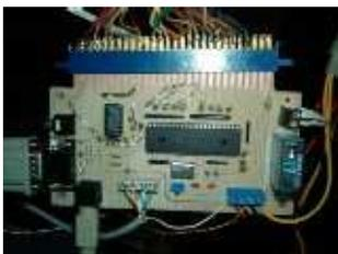
Básicamente lleva el PIC que se conecta a los diferentes botones y al teclado y un dispositivo para cortar la conexión entre el monitor y el ordenador cuando las frecuencias no están bien puestas (no hago ninguna comprobación, lo hago por tiempo).
