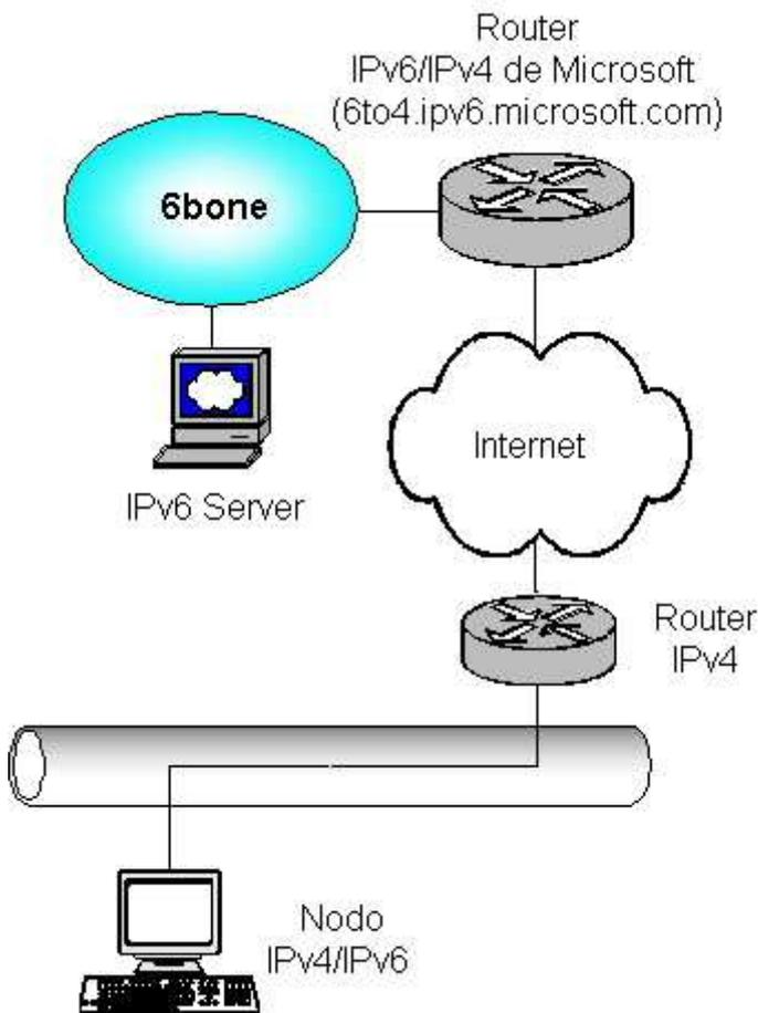
Se creará un túnel IPv4 sobre el que se encapsularán tramas IPv6. Cualquier petición a una dirección IPv6 que no vaya contra nuestra red, se dirigirá hasta la máquina de Microsoft, quien nos dará acceso a la máquina IPv6 a través del 6Bone.
