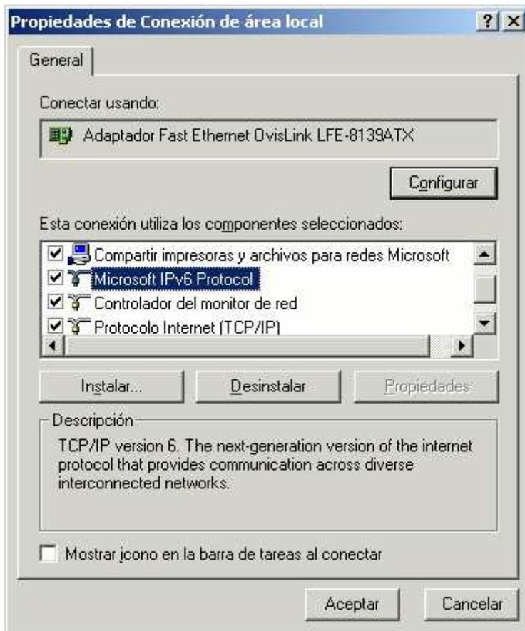
Tal y como puede verse en la pantalla anterior, el nuevo protocolo no tiene ninguna opción de configuración (el botón de propiedades del protocolo está deshabilitado). La configuración del protocolo se hace de forma automática según el método "stateless". En caso de que tengamos un router IPv6 este nos configurará nuestra dirección de red, en caso de no tenerlo se nos pondrá una dirección de la red FE80::/64.
